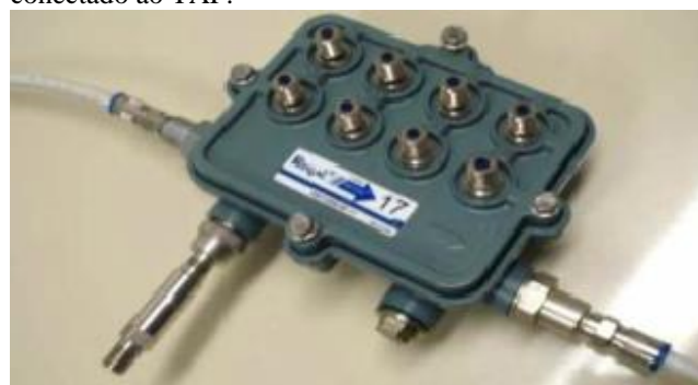
Figura 10: Adaptador de engate rápido e filtro passa baixa conectado ao TAP.
